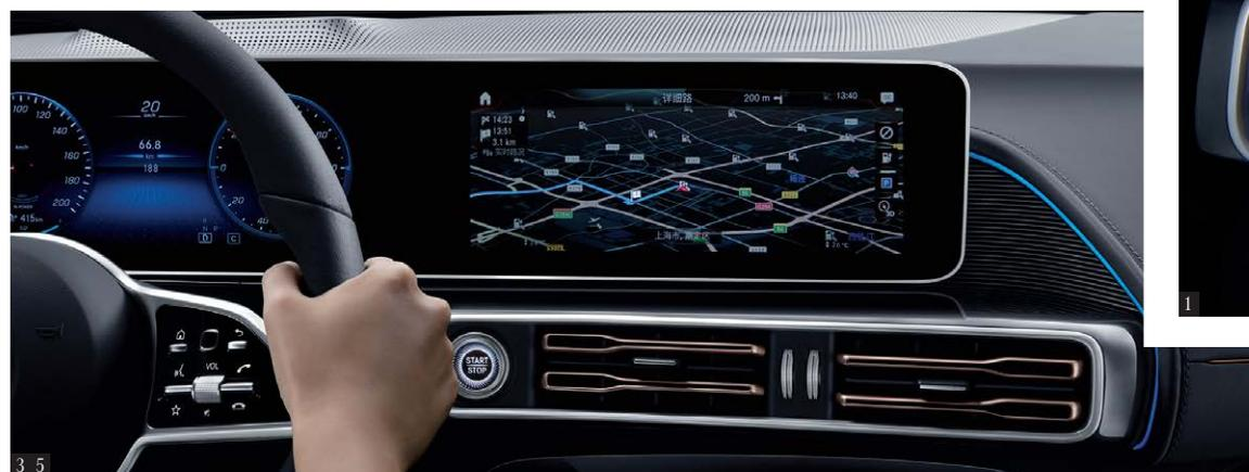
③ 运筹千里路径优化(EV优化路径规划)：可根据当前能耗值、路况、充电站/桩信息等实时信息来实时优化导航路径规划(提供最快、最短和里程方案最优的三套解决方案)。
